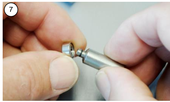
7 Trek het voorste lager van de schacht.
