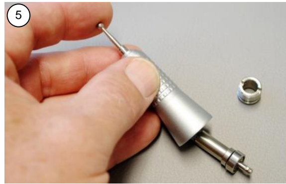
5 Verwijder de klemkamer. Wanneer de klemkamer niet uit zichzelf uit de behuizing glijdt, kunt u de testfrais in het handstuk aanbrengen en deze gebruiken om de klemkamer eruit te drukken.
